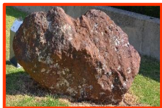
Gossan: oxidación de los sulfuros masivos polimetálicos.
